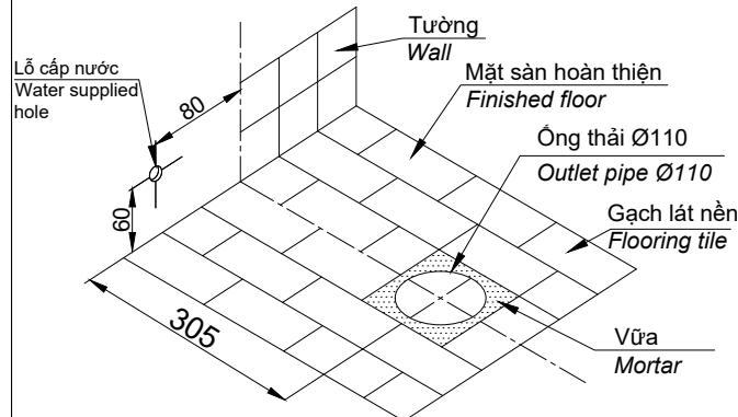
**Chú ý:** Trường hợp khi cắt gạch không làm kín khít xung quanh ông thải thì phải làm phẳng với vữa và cao bằng mặt sàn hoàn thiện. Vữa phải khô mới được tiến hành các bước tiếp theo.
