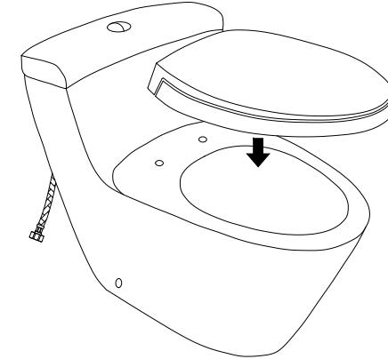
14. Đặt bàn cầu vào vị trí lắp, để lại khoảng trống đủ để lắp dây cấp vào van dừng. Lắp dây cấp với van dừng và dây kịch bàn cầu khớp với đầu lỗ cố định đã lấy.
