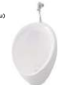
U104W/F Tiểu nam treo tường (Đường cấp nước phía trên) Kích thước: 340x320x540mm Lượng nước xả tối thiểu: 2.0L Bao gồm nối tường và cút nối
